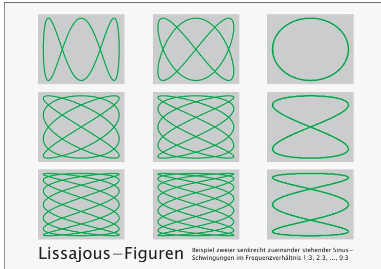
Zwei zueinander senkrecht stehende Sinus-Schwingungen produzieren Lissajous-Figuren. Schön anzusehen beispielsweise auf einem Oszilloskop. Wenn die Frequenzen der beiden Schwingungen in einem rationalen Verhältnis stehen, entsteht ein stehendes Bild. Das Bild ist außerdem vom Phasenunterschied der Schwingungen abhängig. Die Karte zeigt die Kurven für Frequenzverhältnisse 1:3 bis 9:3 bei einer Phasenverschiebung von  $\pi/2$ .
